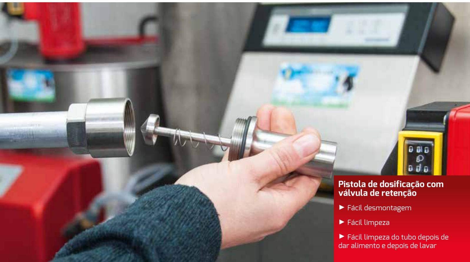
**Pistola de dosificação com válvula de retenção**
